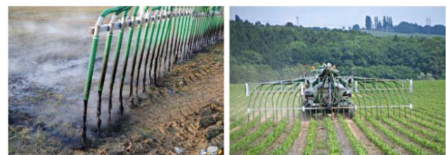
Рис. 3. Поверхнєве внесення рідких органічних добрив через розподільник з системою напіпних шлангів
