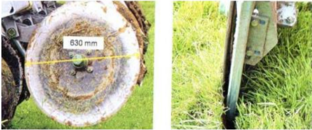
Рис. 4. Внутрішньогрунтове внесення під тиском рідких органічних добрив у відкриті борозни
