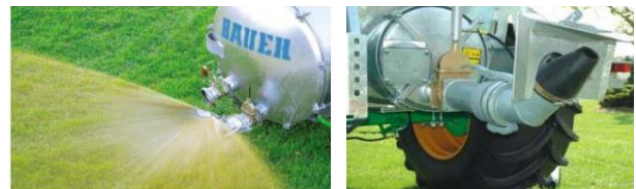
Рис. 2. Поверхнєве внесення рідких органічних добрив розбризкуванням
